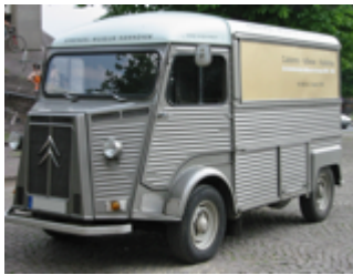
Camionnette en tôle ondulée
